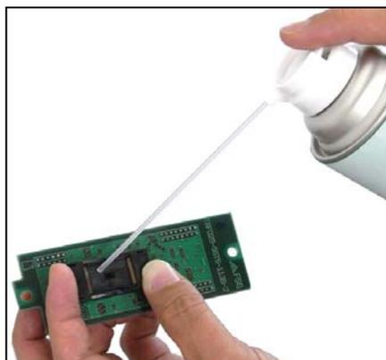
エア-またはエアースプレー等でデバイスリードと接触するソケットのピンの接点部分の埃を吹き飛ばします。
