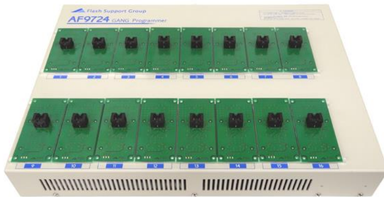
AF9724 (SPIフラッシュ専用アダプタ搭載例)
